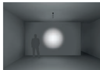
M - Medium \alpha 16^\circ-25^\circ
